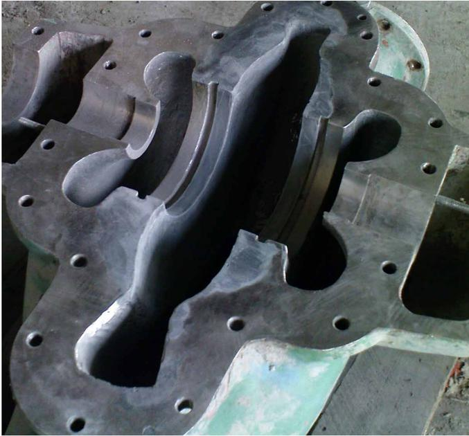
贝尔佐纳(Belzona) 1121 (超级XL金属) 是一种冷固化、100%固体并用硅钢合金增强的环氧复合材料。该材料非常适合于需要较长操作时限的炎热气候或大面积区域施工场合。
